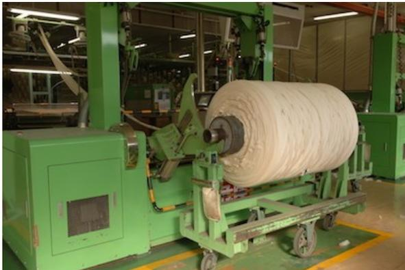
**2 整経** 紡績された糸、約 600 本を、約 6,000 ヤードの長さでロープ状に束ねます。次の染色工程で糸をムラなく染め上げるため、すべての糸を均一に巻き取ることが大切です。整経機には、数多くの工夫が凝らされており、一連の設備・機械はカイハラが独自に開発したものです。
