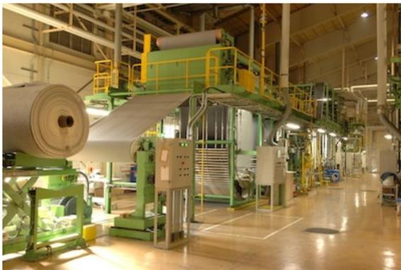
**7 整理加工** 整理加工は、製品として最終仕上げの工程です。中間検査を終えた原反は、表面のケバを取る毛焼き、生地のコシを持たせる糊付け、ヨジレを防ぐ斜行防止、生地の縮みを防ぐ防縮などの処理工程を経て、ユーザーの望む風合いのデニムに仕上げていきます。一連の工程は、自動化され、連続処理をしています。
