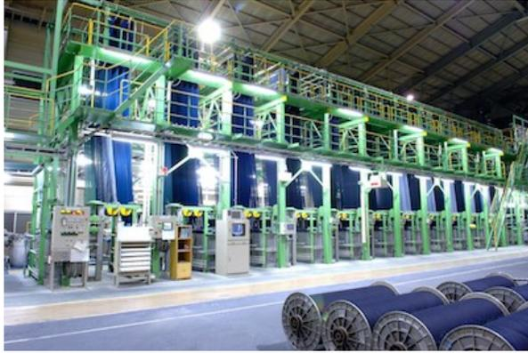
**3 染色** デニムの表情を決定づける重要な工程が染色です。染色工程は備後緋の藍染で培ってきた経験と技術が最大限に生かされている部門です。ロープ状に束ねられた原糸はインディゴ液の中を通過し、ローラーで絞られ、空気に触れることにより酸化し、藍色が発色します。それを何回も繰り返すことで、鮮やかなインディゴブルーに染め上がります。
