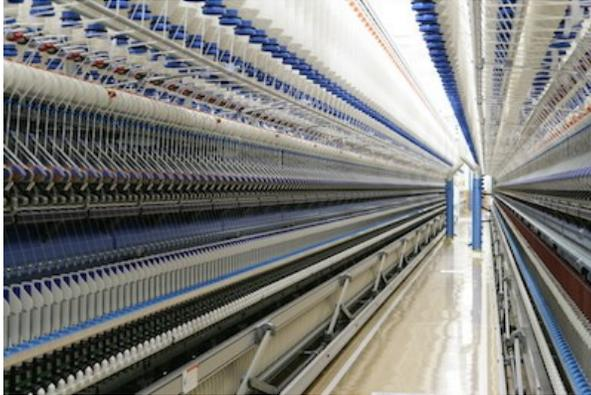
**1 紡績** デニムに最適な厳選された原綿を輸入、デニムの仕上がりまでも想定した独自のノウハウで混綿。リング紡績とオープンエンド紡績があり、求める糸質によって使い分けています。工程間は、搬送ロボットで結ばれ、ほぼ無人化されています。
