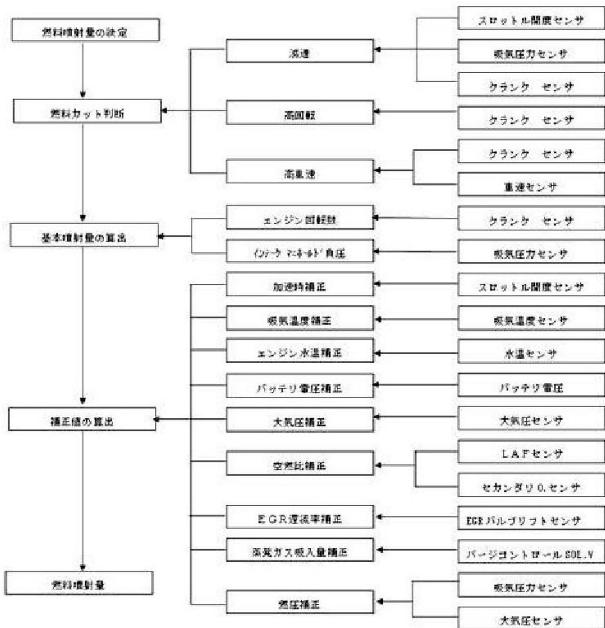
図 142 燃料噴射量の決定（出典：科学技術振興機構）
