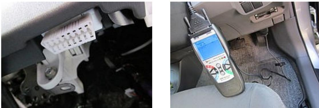
図 66 実際の OBD2 の DLC (データリンクコネクタ) とスキャンツール
