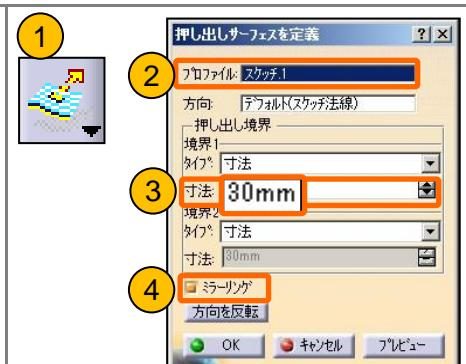
サーフェスのエッジを利用して、【押し出し】でサーフェスを作成します。(両サイド共)
