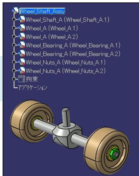
④新規プロダクトファイル(トッププロダクト)を作成し、子部品を取り込みます。
